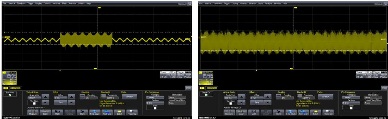
Figure 3-9: mesure de trames CPL Linky en courant – en aval du compteur, avec la charge n°4 « chargeurs / alimentations » - compteur G1 (à gauche) et compteur G3 (à droite)
